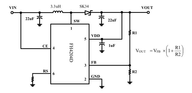
注:芯片 5 脚 VDD 端可以接 VOUT 也可以接 VIN,当 VIN<5V时,建议接 VOUT 来增强驱动能力。
